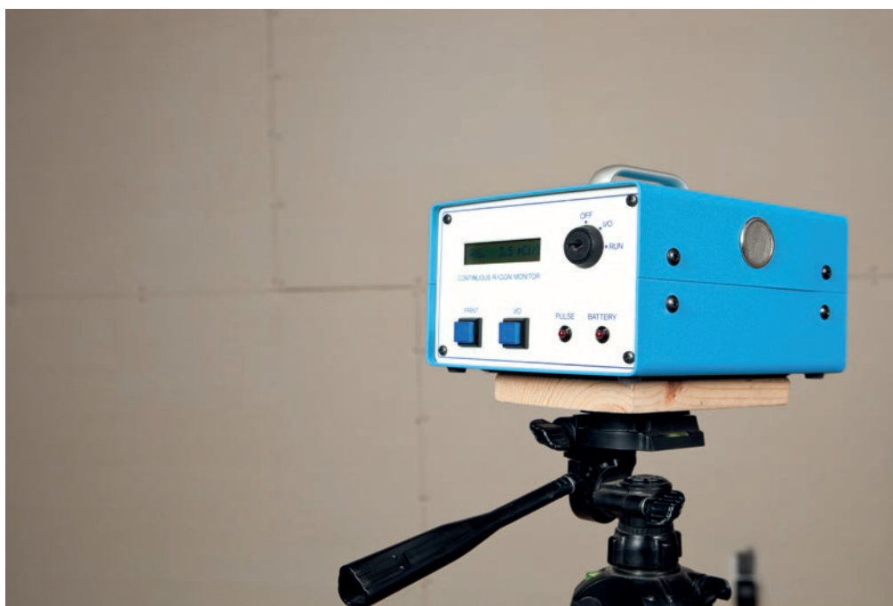
Rys. 3. Elektroniczny monitor czasu rzeczywistego do pomiarów stężenia radonu – urządzenie umożliwiające bieżące monitorowanie poziomu radonu w powietrzu, źródło: istockphoto.com
